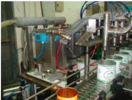
Coriolis en acción en una factoría de envasado de aceite de oliva
