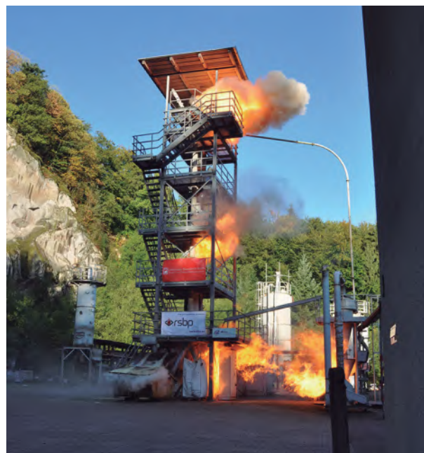
FIGURA 1. Explosión de polvo de malta en un elevador de cangilones
