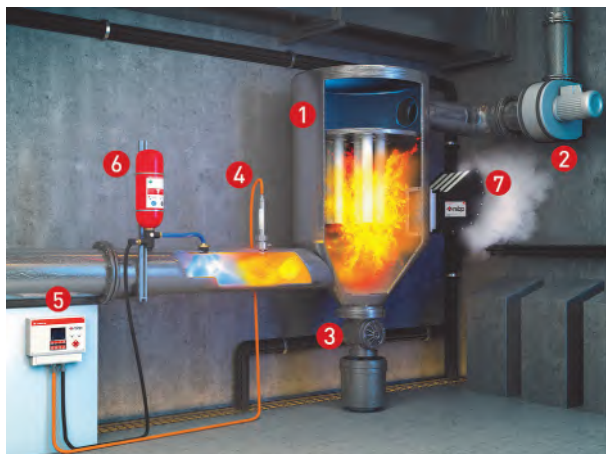
FIGURA 8. Ejemplo de protección contra explosiones en un filtro de aspiración (aplicación interior)
