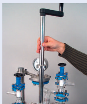
Height adjustable stirrer for optimal loosening, pressing and flattening of filter cake Höhenverstellbarer Rührer für optimales lockern, anpressen und streichen des Filterkuchens
