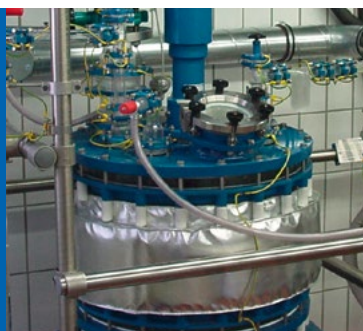
Reactor with removable insulation Reaktor mit demontierbarer Isolation
