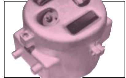
Los amortiguadores de pulsación con enchaquetado ControHeat en aplicaciones a alta temperatura proveen un servicio crítico para los instrumentos y medidores aguasabajo. La chaqueta mantiene en estado líquido el fluido de proceso estancado que se encuentra debajo del colchón de gas del amortiguador.
